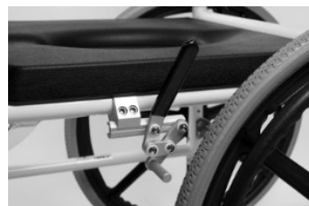
Abb. 4: Befestigung der Bremsen am Rahmen
