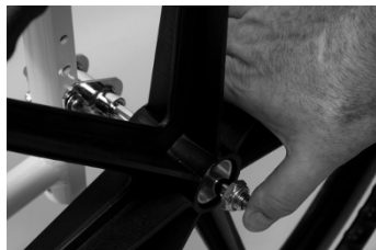
Fig. 2: 24"-hjulet med hurtigudløser
