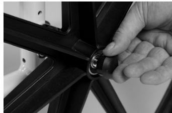
Rys. 3: Osłona na przycisk szybkozłączki
