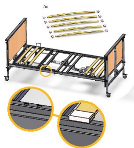
Montaż lamel drewnianych
