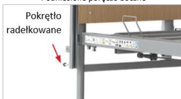
Ponowny montaż pokrętła radełkowanego
