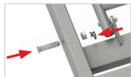
Montaż sworznia, zawlecзки 'R' i plastikowej tulei
