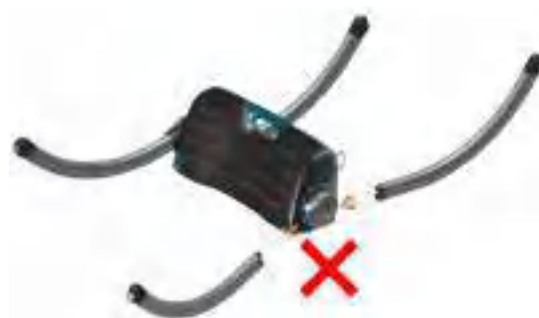
Nieprawidłowa kolejność montażu (nogi NIE powinny być montowane jako pierwsze)
