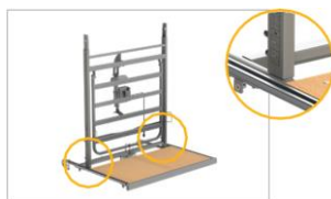
Montaż sekcji pleców platformy materaca i szczytu łóżka
