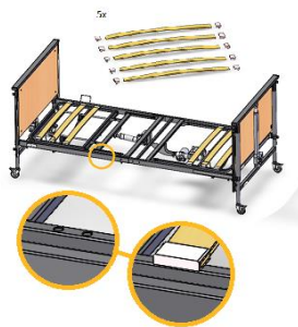
Montaż lamel drewnianych
