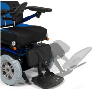
BZ10E - podnóżek jednopłytkowy z automatyczną regulacją kąta nachylenia.
