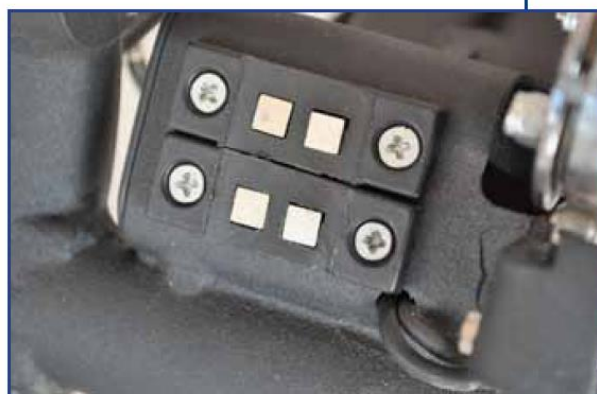
33 Styki elektryczne na spodzie wspornika
